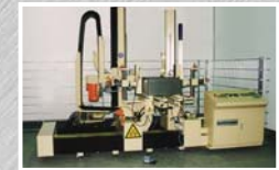
Schleifautomat für die Bearbeitung geschweißter Ecken Automatic Belt Grinding Machine for the processing of welded corners
